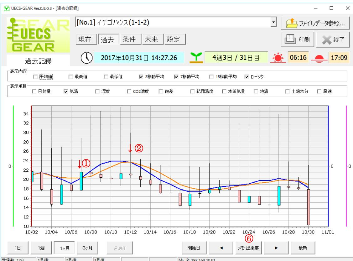
上のウインドウは、気温についての平均値、最高値、最低値、ローソク足、3日間と7日間の移動平均を示したもので。表示間隔は1か月間ですが、マウスのドラッグで一部を拡大して表示させています。各ローソク足は、下から、その日の最低値、その日と翌日の午前0時(設定により日の出)の値で、当日<翌日なら空色、当日>翌日なら赤色、そして、その日の最高値の4本値を示します。変動する相場の傾向を見るために使用される手法です。10/3～10/7までは、色付けされた箱が長いことから、毎日の昼夜の変動より、2～3日間隔で日毎に気温が上下に大きく変動していることを示しています。逆に、10/8以降は、1日間の昼夜の気温変動が大きく、日毎の変動はあまり無いことを示しています。
