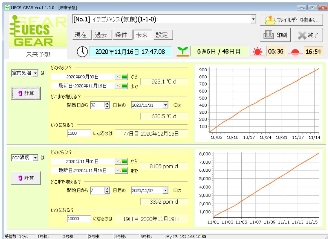
上は、気温(日積算日平均気温)と、CO<sub>2</sub>濃度(日積算日平均CO<sub>2</sub>濃度)での計算と予測例です。積算範囲内にデータが記録されている時にはその値、それ以外の場合は平均値を外挿して積算値を求めています。この画面を使い、収穫日の予測、栽培管理作業計画策定の参考などに活用することができます。
